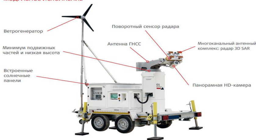
1 - сурет. IBIS ArcSAR георадарының құрылымы
