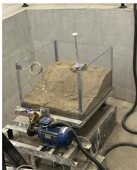
Рисунок 5. Испытательный стенд с установленными датчиками после первого испытания без усиления откосов.
