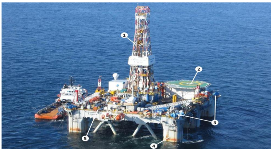
1.Бұрғылау вышкасы; 2.Тік ұшақ площадкасы; 3.Якорьлық жүйе; 4.Корпус; 5.Палуба
