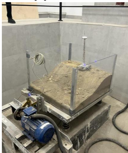
Рисунок 4. Испытательный стенд с установленными датчиками до первого испытания без усиления откосов.
