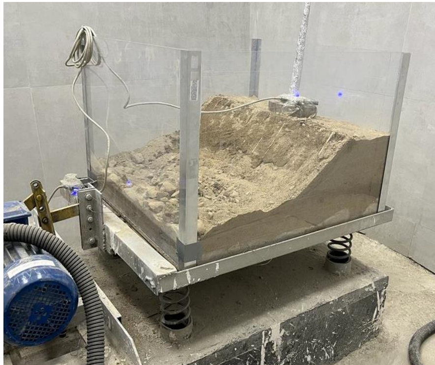
Рисунок 6. Испытательный стенд с установленными датчиками до второго испытания.
