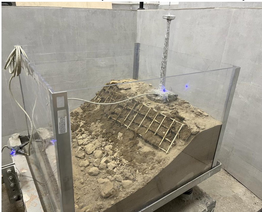
Рисунок 7. Испытательный стенд с установленными датчиками после второго испытания.
