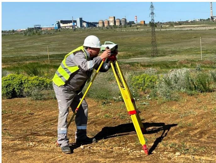
Сурет 1. Бөгетте орналасқан топырақ реперлерін түсіру
