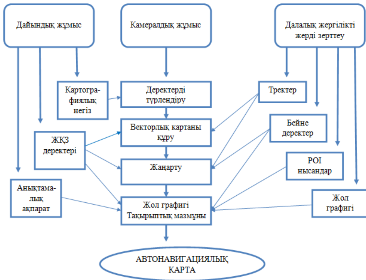
1-сурет. Автонавигациялық электрондық картаны жасаудың технологиясы
