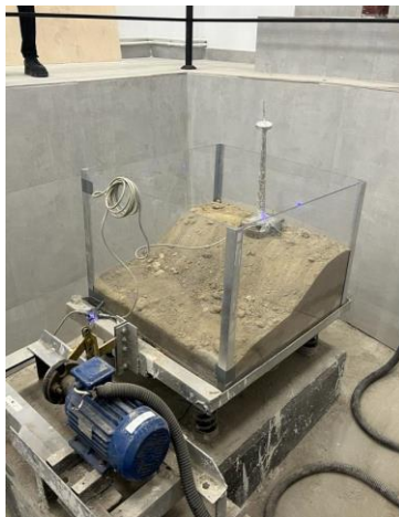
Рисунок 4. Испытательный стенд с установленными датчиками до первого испытания без усиления откосов.
