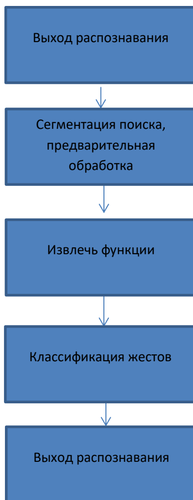
Рисунок 1. Базовый процесс распознавания жестов
