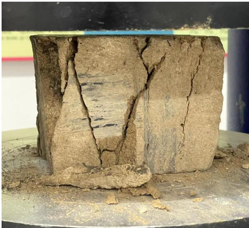
Рис.1. Пример разрушения образца после инъектирования
