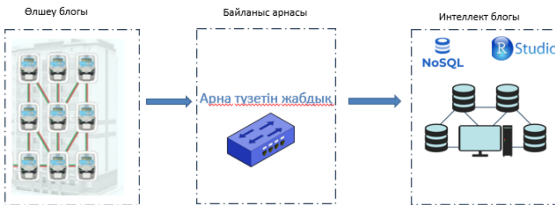
1.1 Сурет. Тұтынушы үшін электр энергиясын интеллектуалдық есептеуге арналған цифрлық кешеннің типтік архитектурасы
