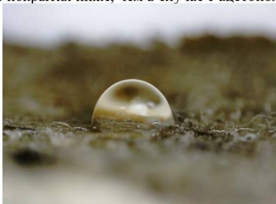
Рисунок 2. Лен, обработанный раствором пчелиного воска в изопропиловом спирте
