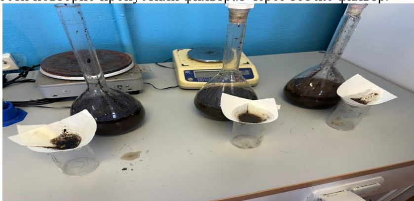
Рисунок 1. Процесс фильтрации водной вытяжки почвы
