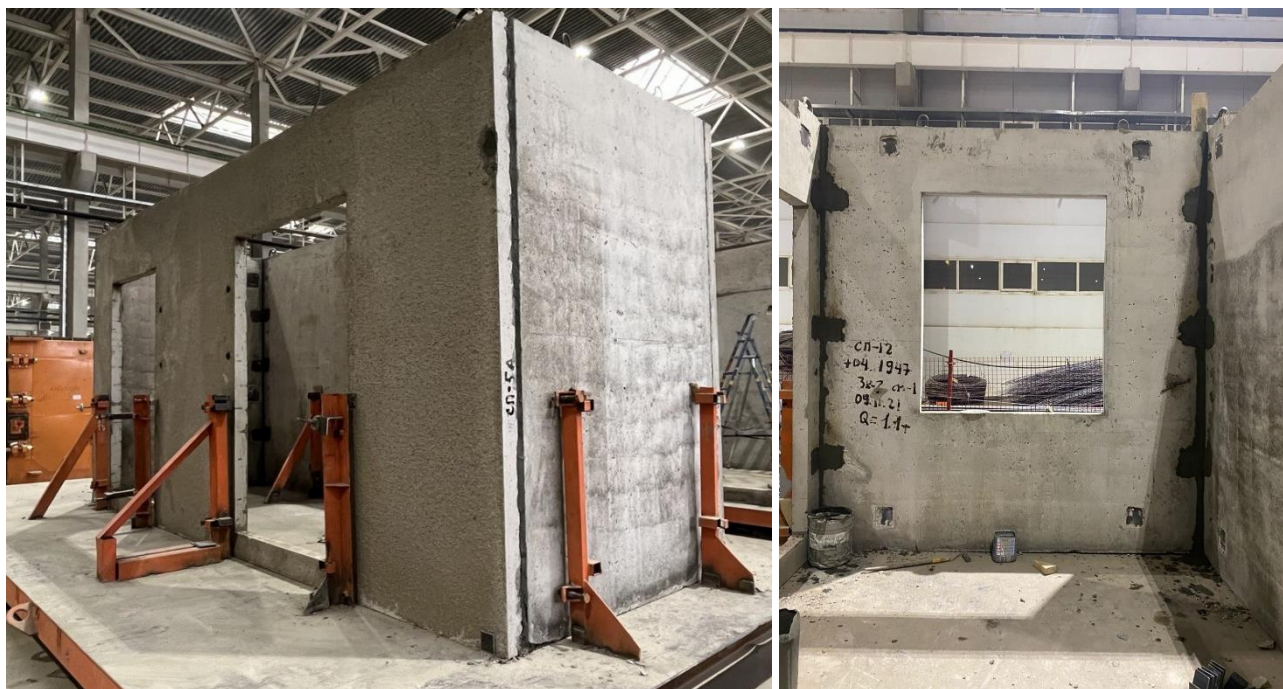
Рис.1 Сборный железобетонный блок (Завод «ModeX Astana», г. Нур-Султан)
