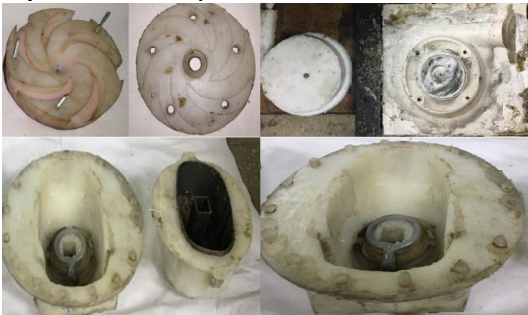
Рис 1. Отливки форм насоса из силикона
