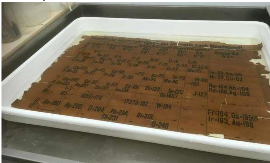
Сурет 2. Табылған кестені қалпына келтіру: мата негізінен бөлінген мәтіні бар сақталған қағаз \text{Mg}(\text{HCO}_3)_2 магний бикарбонаты ерітіндісіне батырылған.
