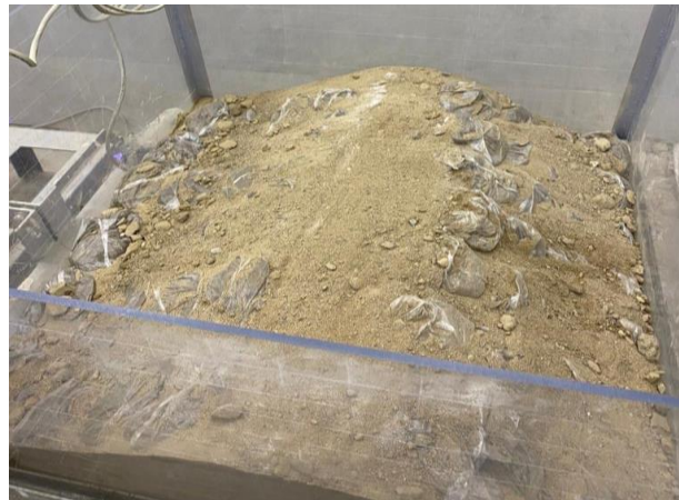
Рис.7 – При усилении с полимерными материалами, выдержало более 9 баллов
