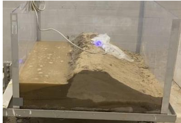
Рис.5 – второй эксперимент с водонасыщением, частота была увеличена до 7-8 Гц
