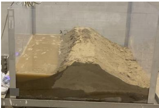
Рис.5 – второй эксперимент с водонасыщением, частота была увеличена до 7-8 Гц
