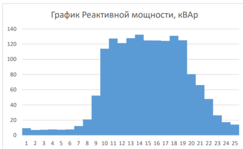
5-сурет - 30 үшін ТП-5172 реактивті қуат жүктемесінің графигі 2024 жылдың қаңтары
