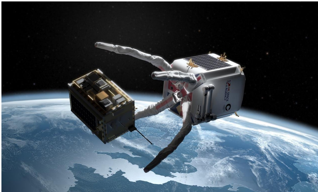
3-Сурет. Роботтық спутник арқылы қалдықтарды жою механизмі
