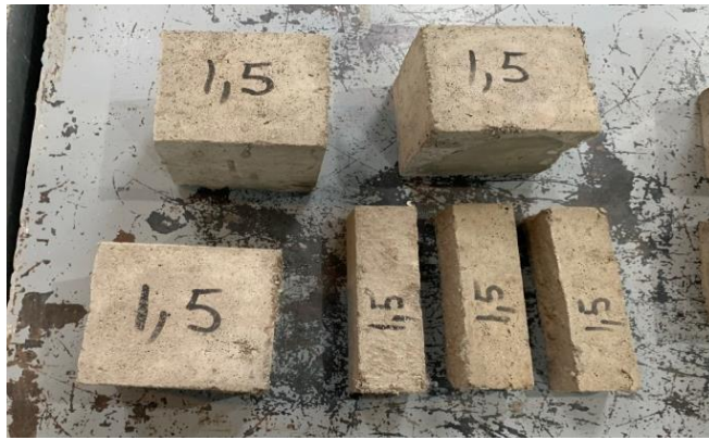
Сурет 1. Құрамы 1,5% органикалық талшықтарымен нығайтылған бетон үлгісі
