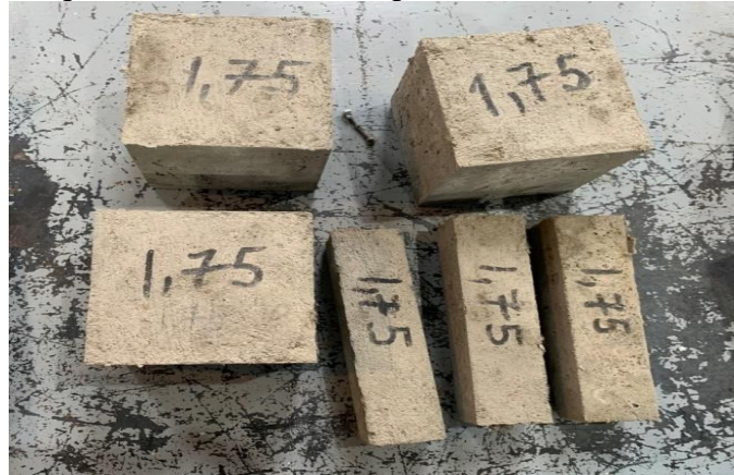
Сурет 2. Құрамы 1,75% органикалық талшықтарымен нығайтылған бетон үлгісі
